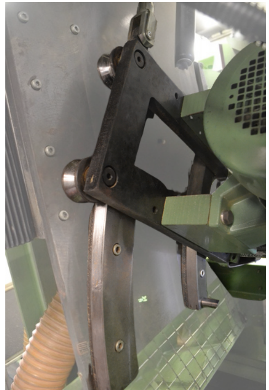
Herramienta en posición baja, es decir, en posición de corte.
