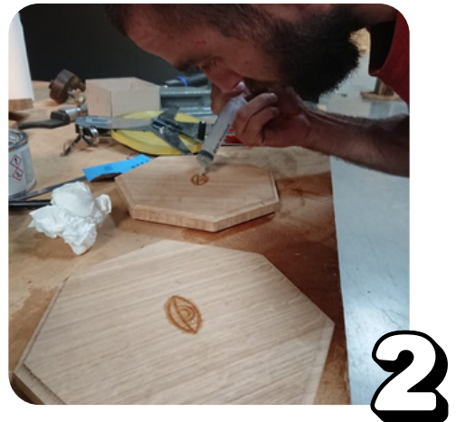
Rellenar el grabado con resina epoxi
